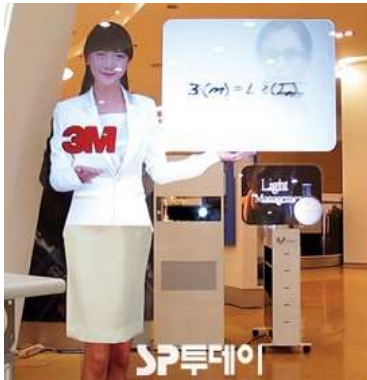
▲ 사람 형태의 화면을 통해 실제 사람이 말을 하고 움직이는 것과 같은 효과를 연출하는 '팝스크린 마네킨'
